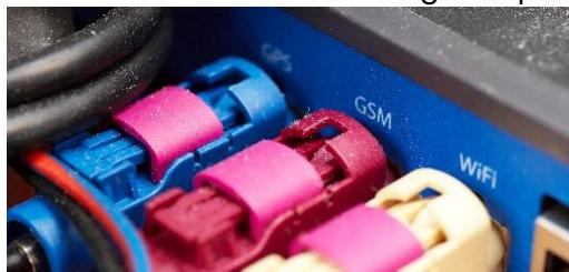
3. Kör systemtestet "GPS". Om OK (kontakt med GPS), gå vidare med testet nedan. EJ OK: Byt antenn.
